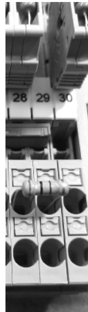
8-сур. РТС датчигін қосу клеммаларында кедергі (резистор) орнату мысалы
